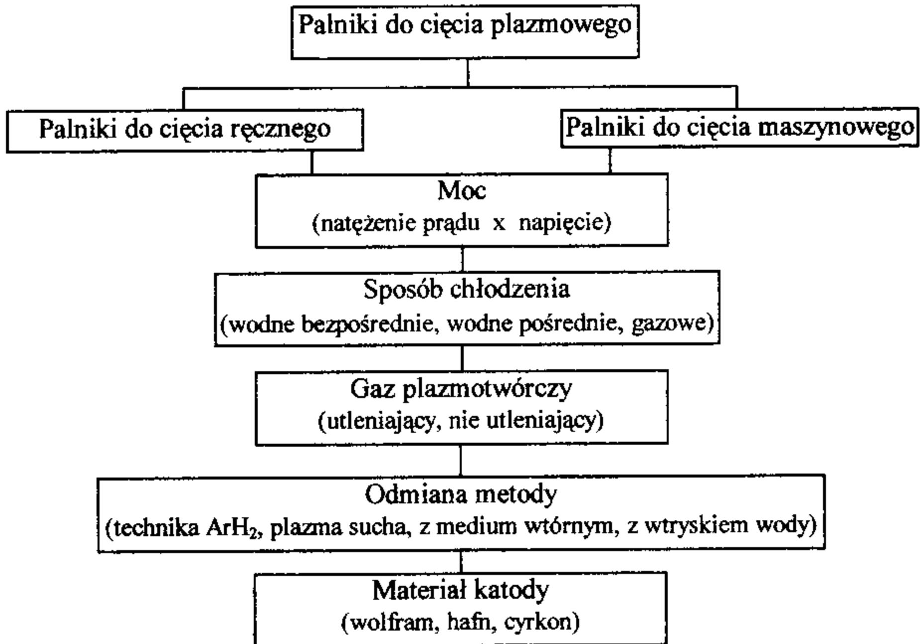
Rys. 14.8. Możliwe rodzaje konstrukcji palników plazmowych
